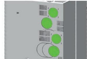
Die vormontierte Gebläseeinheit muss zur Montage zerlegt werden. Lösen Sie die Schrauben und entfernen Sie das gesamte Gebläsegehäuse mit Motor und die ovale Fühlerabdeckung. Nehmen Sie die mit Kabelbinder gesicherte Kabelabdeckung ab.
