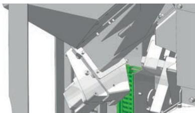
Drehen Sie die Sechskant-Mutter bis an das Ende der Gewindestange. (Die Befestigungspositionen sind als Schlüssellocher ausgeführt.)
