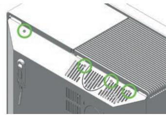
Je nach gewünschter Option schneiden Sie für ein Gebläse die oberen zwei Markierungen aus, für das zweite Gebläse zusätzlich die unteren zwei.
