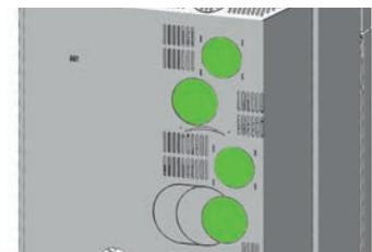
L'unité de soufflerie pré-installée doit être démontée. Dévissez les vis et ôtez le boîtier complet de la soufflerie, avec le moteur et le cache ovale du capteur. Retirez la protection de câble avec ses attaches.
