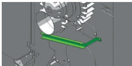
Per fissarlo e evitare eventuali vibrazioni girare i due nasi (si trovano in posizione diagonale) con l'aiuto di una pinza.
