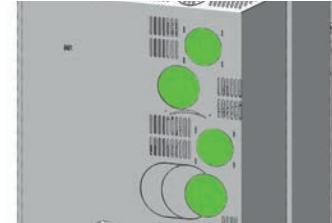
L'unità della ventola premontata va smontata per il montaggio. Svitare le viti e togliere tutta la parte esterna della ventola insieme al motorino e la cover ovale del sensore. Togliere la cover dei cavi.
