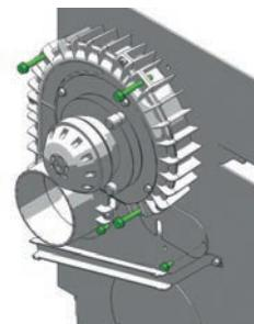
Montare la lamiera condotta aria inferiore alla piastra di supporto della ventola.
