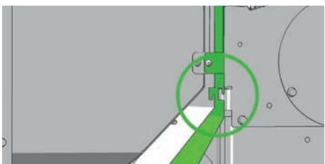
Führen Sie die Kabel zwischen dem in der Abbildung durchsichtig dargestellten Zuluftrohr und dem Fördertröpfchen nach hinten zu dem grün markierten senkrechten Kabelkanal.
