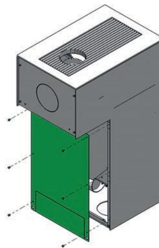
Découpez la paroi arrière le long des perforations avec une lame de scie à métaux.
