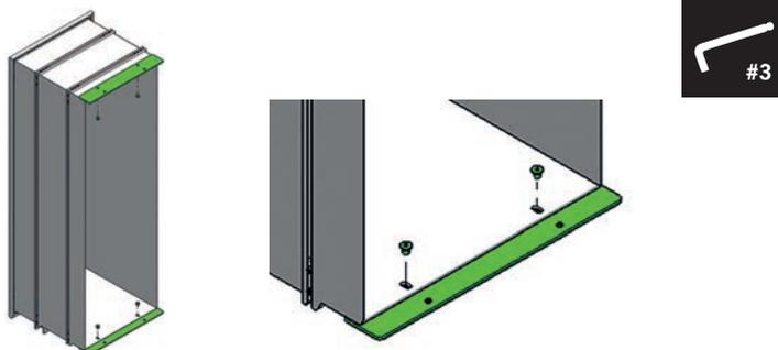
Poussez les deux compartiments de chaque côté, sous l'arrière du poêle, dans l'espace libre entre le poêle et le mur.
