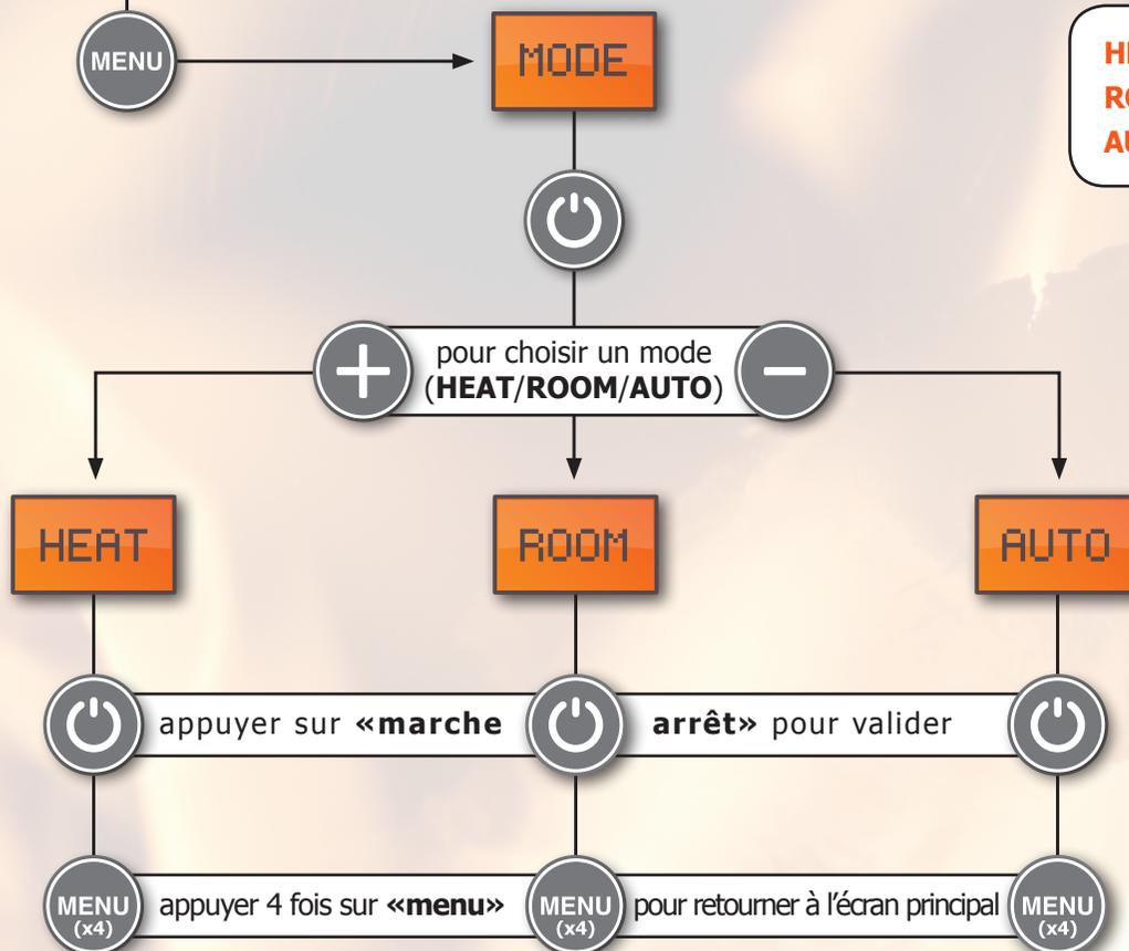
**HEAT** : Mode de fonctionnement **par puissance de 30 à 100 %**
